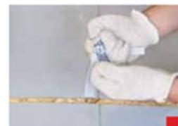
Para verificar la calidad de la soldadura usar una tira (min. 30 mm) de 2 membranas soldadas. Cortar la tira y separar con las manos 2 membranas soldadas. La rotura de una soldadura de alta calidad debería producirse en el material quedando al descubierto la malla de refuerzo y la soldadura no debería deslaminarse.
